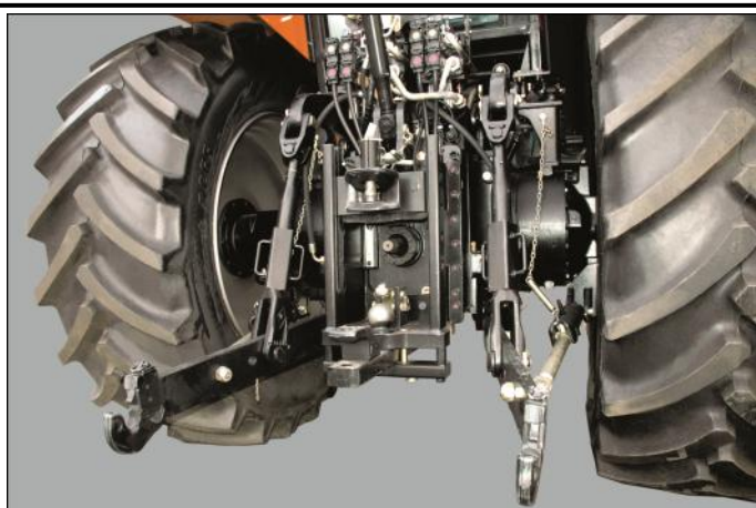
Standaard beschikt de terrion over 3 punts hefinrichting en een aftakas met 3 snelheden (540/750/1000 rpm)
