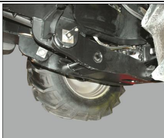
Een luchtgeregelde voorasvering is standaard bij de 50 km versie en optioneel bij de 40 km versie.
